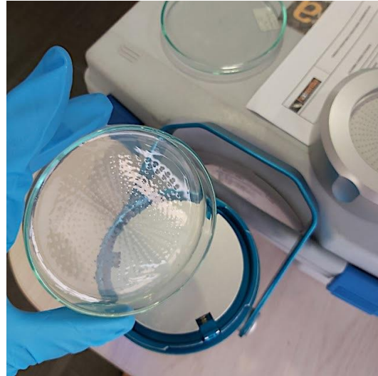
Imagen 23. Rejilla de impactación del aire sobre medio de cultivo primario para el aislamiento de los microorganismos ambientales.
