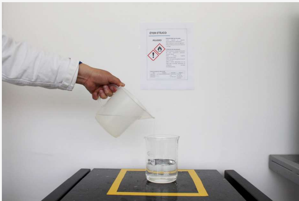
Ilustración 9. Ejemplo de etiquetado de lugares de trabajo donde se utilizan envases de alta rotación
