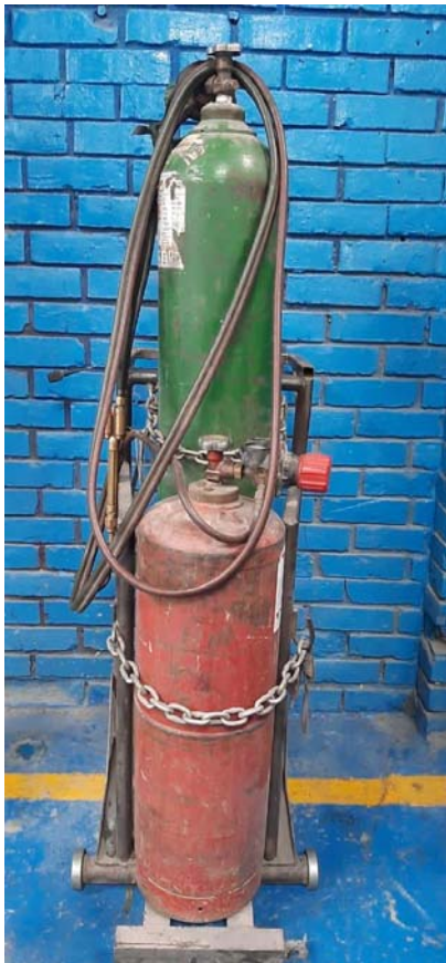
EQUIPO DE SOLDADURA AUTÓGENA.
