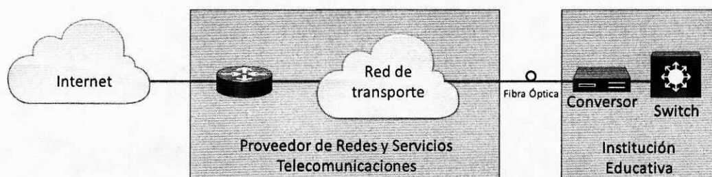
Figura 4. Tecnología de acceso por Fibra Óptica
