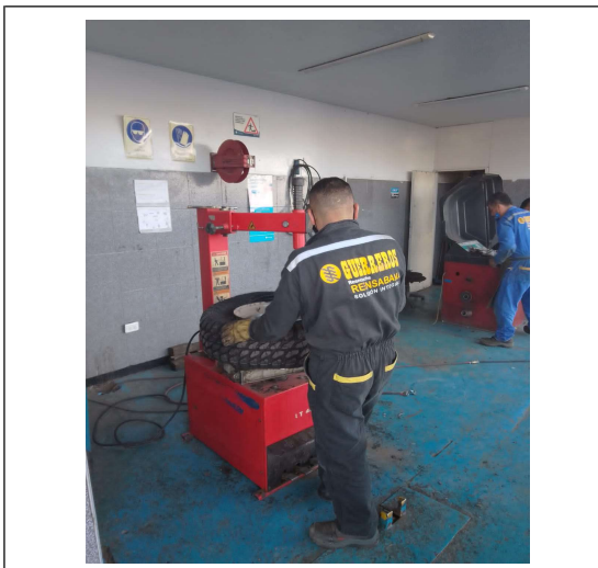
FOTO 5. INSTALACIÓN DE LLANTAS
