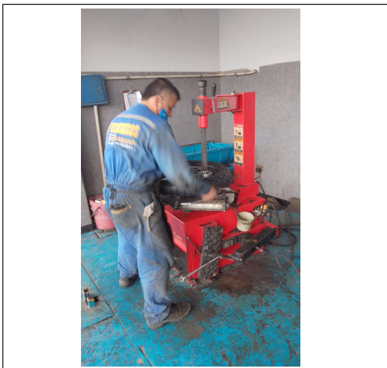
FOTO 5. INSTALACIÓN DE LLANTAS
