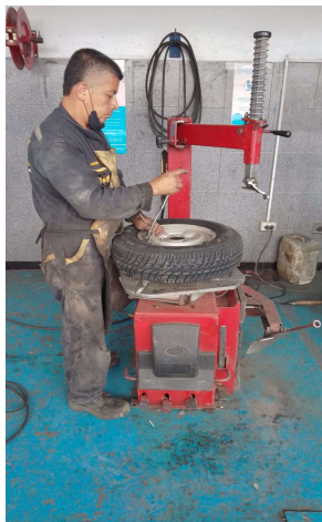
FOTO 5. INSTALACIÓN DE LLANTAS
