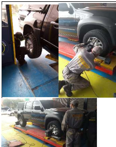
FOTO 5. INSTALACIÓN DE LLANTAS
