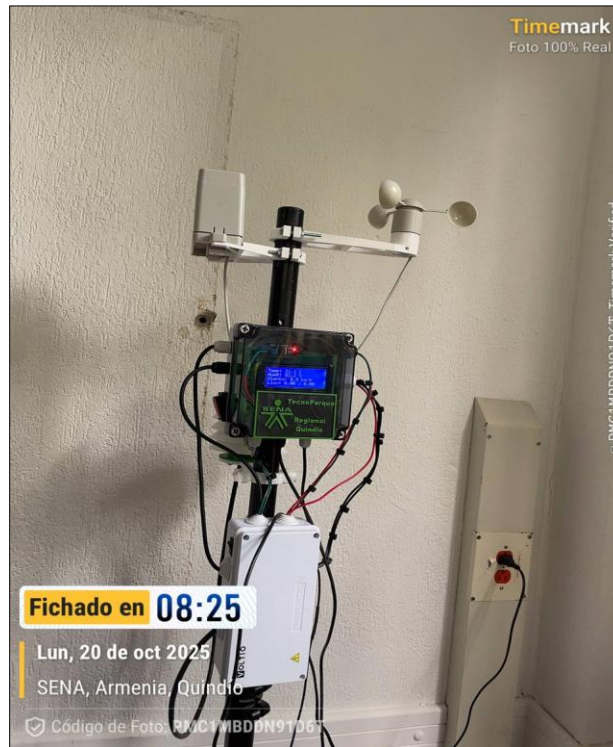
Figura 4- Estación Agrometeorológica V2
