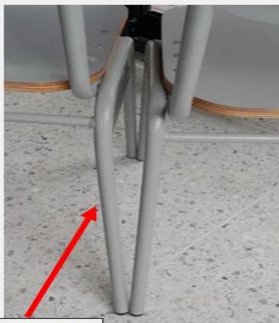
SILLA CON LA PATA DOBLADA POR EMBALAJE
