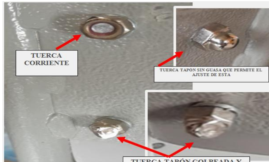
TUERCA TAPÓN GOLPEADA Y DEFORMADA
