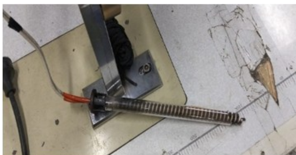
Resistencia afectada y quemada
