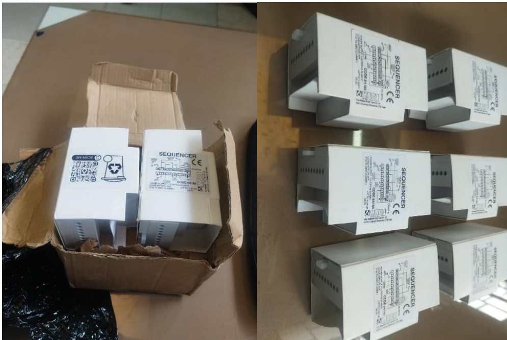
ALTERNADOR DE BOMBAS TIPO RELE 110/220V:
