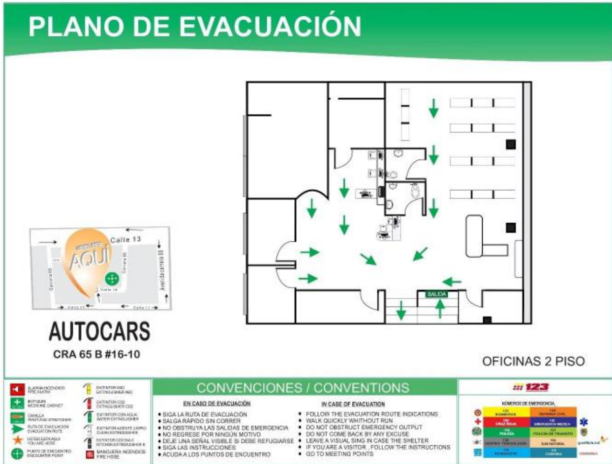
Imagen 1. Plano de Evacuación del segundo nivel.
