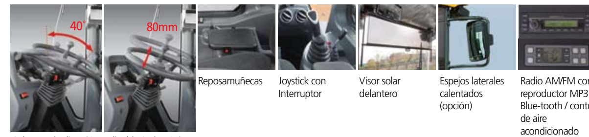
Columna de dirección reclinable / telescópica
